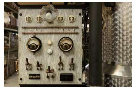
Elektrik: Messgeräte und Schalthebel des Dampfers Beatus, gebaut von Escher-Wyss. (Anklicken für Detailansicht)
