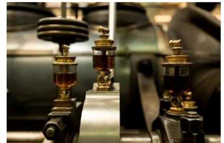
Schmierung: Die zuverlässige Ölversorgung ist das A und O jeder Dampfmaschine.
